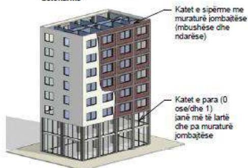
Rasti 2 Ndërtesë shumëkatëshe betonarme
